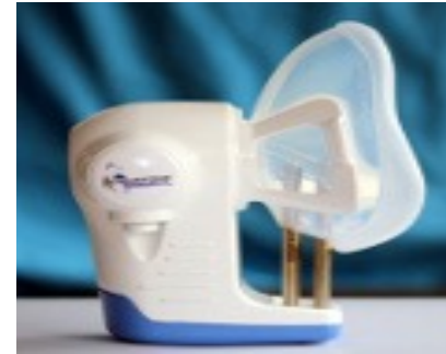
Masque Reciva : tubes Tenax (air exhalé)
